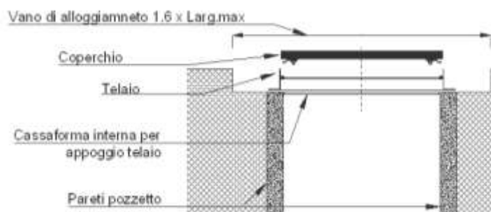
Figura 2 Installazione chiusino quadrangolare
